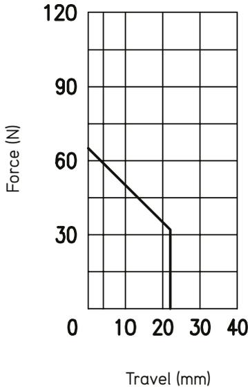
Zur Prüfung der Auslösemechanik in gekapselten Mittelspannungs-Schaltanlagen
